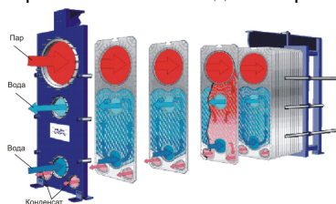
Рисунок 1 – Пластинчатый конденсатор AlfaCond
