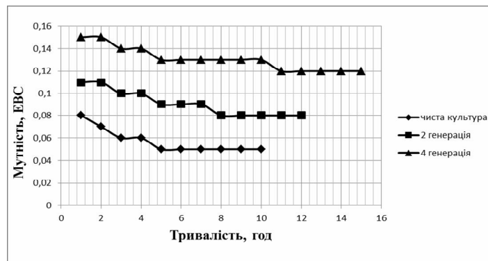
Рисунок 1 – Зміна мутності пива під час фільтрації залежно від генерації дріжджів
