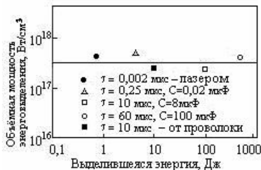
Рисунок 1 - Корреляция между объёмной мощностью инициирующего источника и его энергией при инициировании сферической детонации в стехиометрической ацетиленокислородной смеси (начальное давление 4 кПа) [8]
