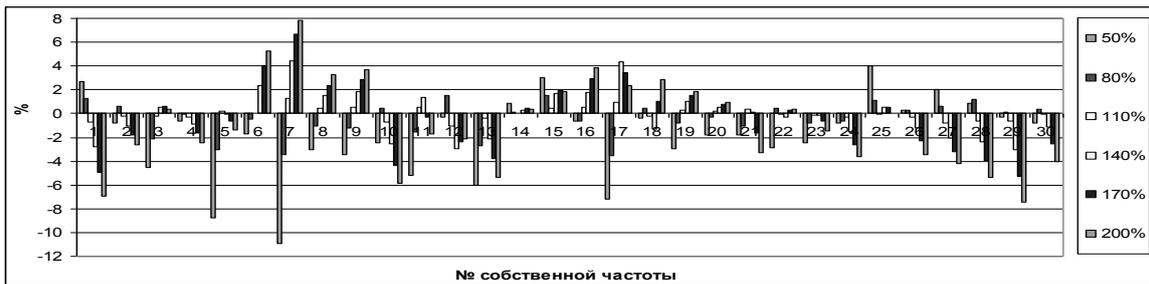
Рисунок 13 – Отличие собственных частот от номинальных, % при изменении толщин раскосов шпренгельной системы крана-перегрузателя ПМГ-20 в диапазоне 50–200%
