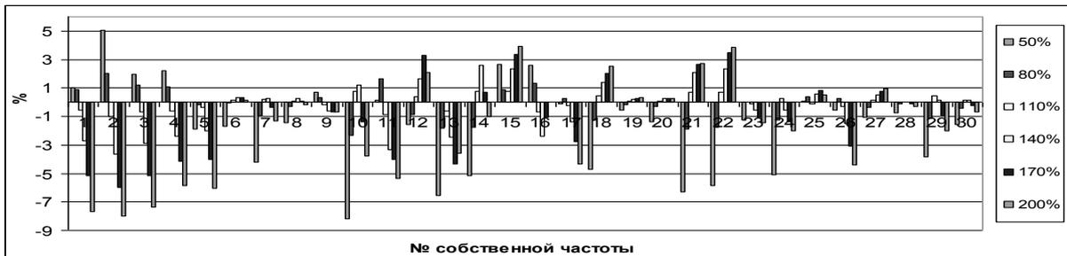
Рисунок 5 – Отличие собственных частот от номинальных при изменении толщин секций главных балок крана-перегрузателя ПМГ-20
