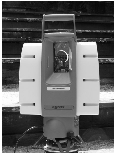
Рисунок 4 - Лидар, предназначенный для дистанционных трёхмерных обмеров зданий
