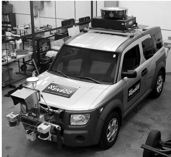
Рисунок 3 - Два чёрных цилиндра, вынесенные перед бампером - сканирующие лидары беспилотного автомобиля
