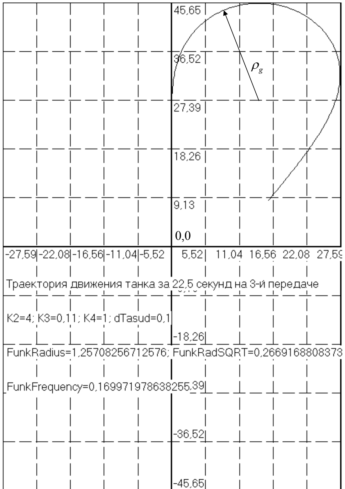
Рис. 11. Траектория движения ВГМ. Поворот вправо на третьей передаче САУП ШИМ . Начало траектории движения в точке (0,0)
