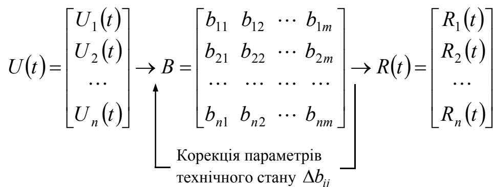
Рис. 2. Структура побудови імовірнісних моделей керуючих впливів на технічний стан об'єктів ремонту
