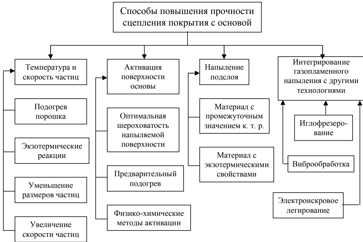
Рис. 4. Способы повышения прочности сцепления покрытия с основой
