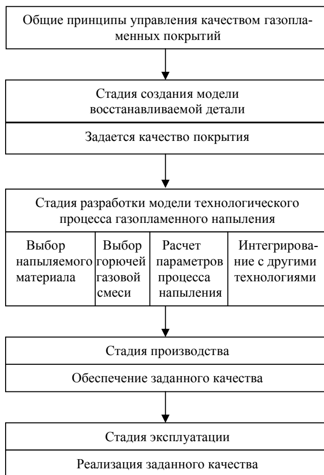
Рис. 6. Структура общих принципов управления качеством газопламенных покрытий
