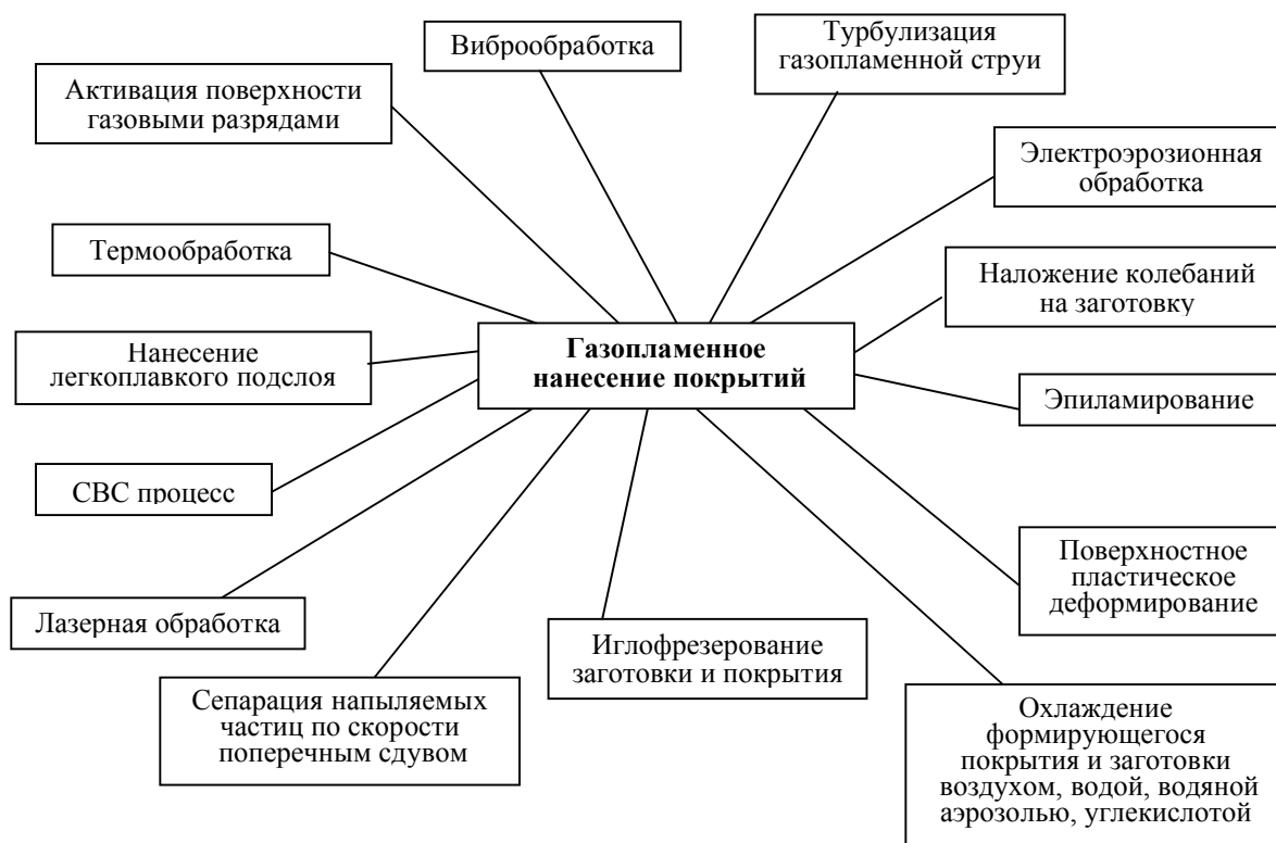
Рис. 5. Схема интегрирования газопламенного напыления покрытий с другими методами обработки поверхности
