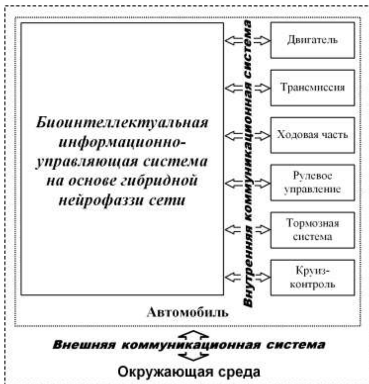
Рис. 4. Пример структурной схемы бортового информационно-коммуникационного комплекса на основе биоинтеллектуальной информационно-управляющей системы
