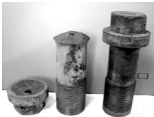
Рис. 1 – Болты крепления рабочего колеса гидротурбины (M110x4) после эксплуатации
