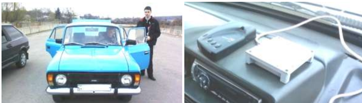
Рис. 5. Испытуемый автомобиль «Москвич-412» и установка на него измерительной аппаратуры
