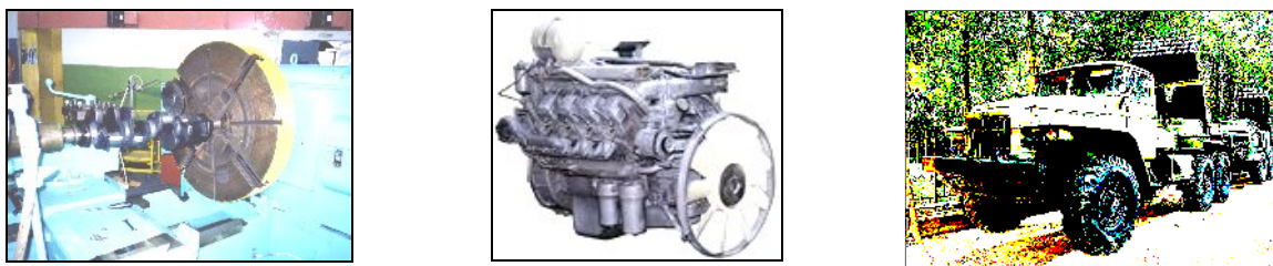
Рис. 5. Дискретно зміцнений колінчастий вал двигуна КамАЗ-740 для оснащення двигуна шасі установки «Град»
