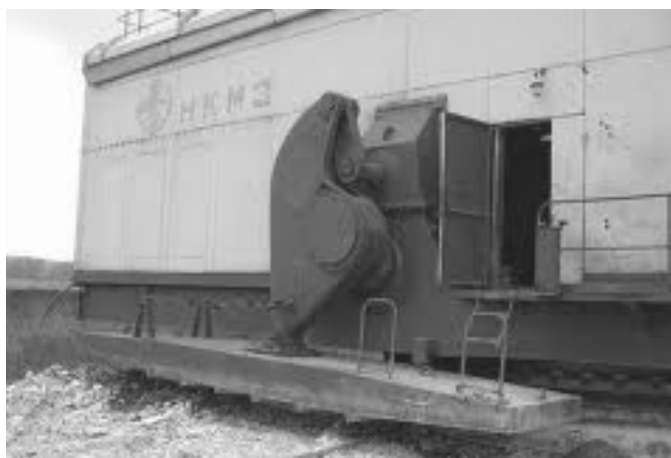
Рис. 1. Кривошипно-рычажная четырехзвенная система механизма шагания драглайна
