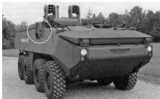
Рис. 4. Блок MCTS 150 на корпусе БМ Piranha.
