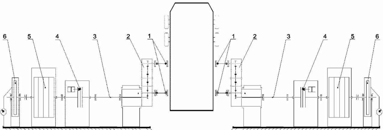
Рис. 3. Схема сборки нагружающих устройств для испытаний колесных БТР
