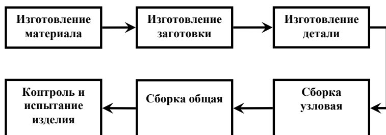
Рисунок 1 – Схема взаимодействия процессов изготовления машиностроительного изделия
