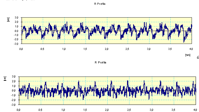
Рисунок 5 – Профилограмма поверхности после шлифования алмазными кругами с частичной заменой на зернистые концентраты – рутил (а) и ильменит (б).
