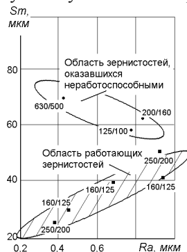
Рисунок 3 – Пример корреляционной связи между высотным параметром Ra и шагом микронеровностей Sm для компактов микропорошков
