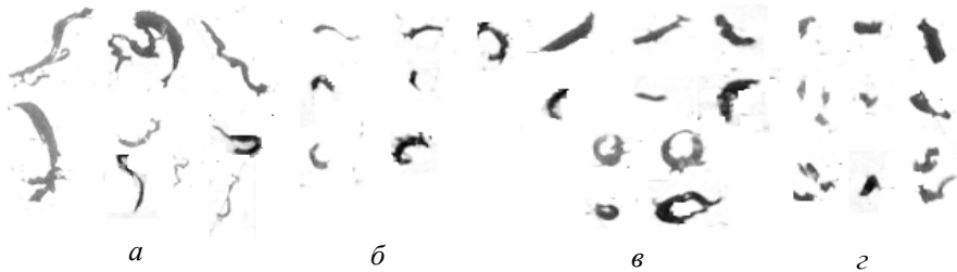
Рисунок 1 – Виды стружек, образующихся при плоском алмазном шлифовании: а – ленточная; б – запытообразная; в – сегментообразная; г – дробленая
