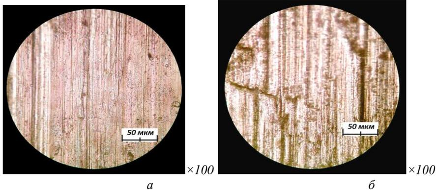
Рисунок 1 – Микрофотографии обработанной поверхности латуни: а – после обработки твердым сплавом «ВолКар», б – после обработки твердым сплавом ВК6.
