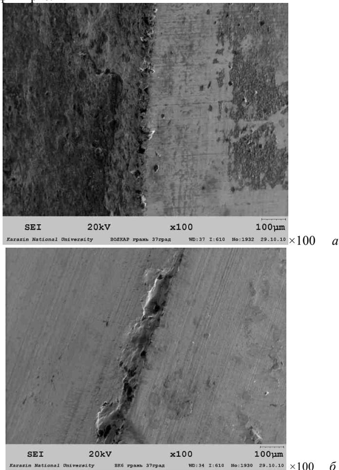
Рисунок 2 – Микрофотографии шероховатости кромки: а – твердый сплав «ВолКар», б – твердый сплав ВК6.
