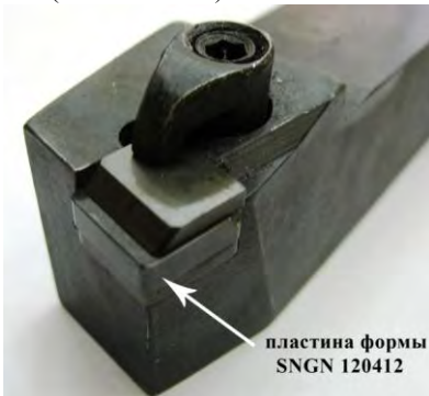
Рисунок 3 – Внешний вид резца, оснащенного пластиной формы SNGN 120412 из керамического материала
