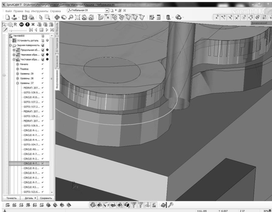
Рисунок 4 – Контроль положения инструмента и снимаемого припуска
