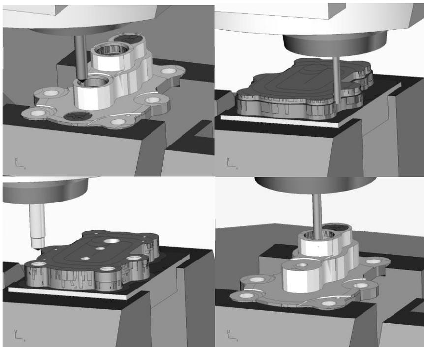
Рисунок 2 – Имитация процесса обработки
