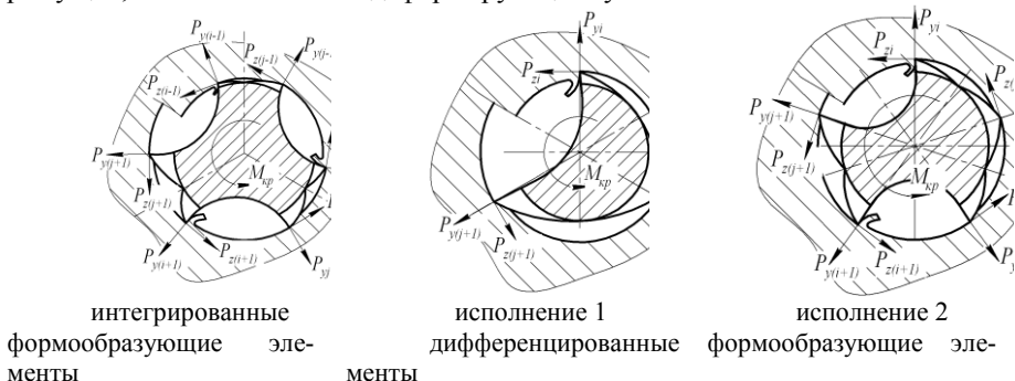
Рисунок 1 – Схема взаимодействия зубьев метчика с обрабатываемым материалом
