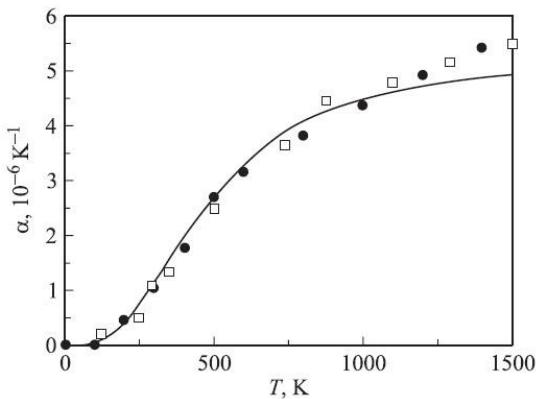
Рисунок 4 – Температурная зависимость коэффициента линейного теплового расширения алмаза
