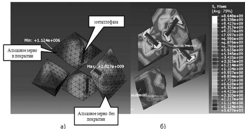
Рисунок 5 – Картина распределения напряжений в окрестности включений металлофаз в алмазном зерне: а – максимальные напряжения 2 ГПа, б – максимальные напряжения превышают предел прочности алмаза и составляют 8.2 ГПа
