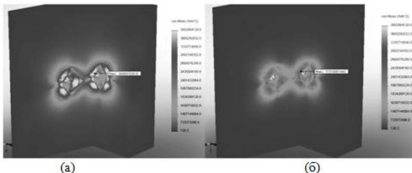
Рисунок 6– Поля приведенных напряжений в системе «алмазные зерна-металлофазы – связка». Вариант расположения зерен при концентрации 100%. а – спекание в системе: модуль упругости связки  $2.44E+11$  Н/м $^2$ , КТР металлофазы  $3.16E-05$  1/К;
