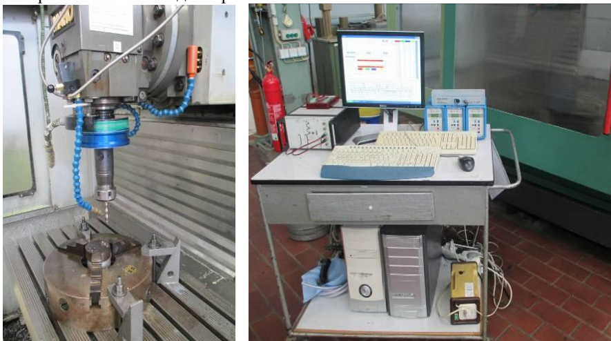
Рисунок 2 – Общий вид и приборное обеспечение экспериментальной установки на базе станка с ЧПУ «МАНО МН 600Е»
