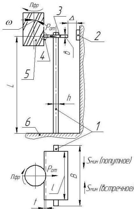
Рисунок 1 – Схема экспериментальной установки для исследования концевого цилиндрического фрезерования тонкостенной детали
