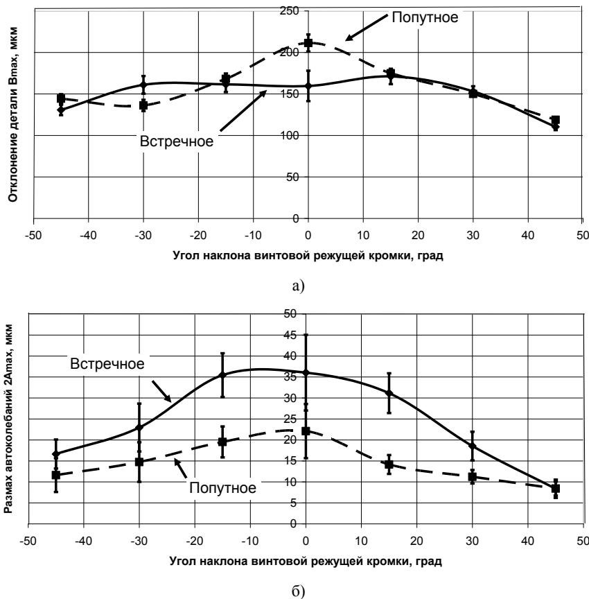
Рисунок 4 – Влияние угла наклона винтовой режущей кромки на величину вынужденных  $B_{max}$  (а) и автоколебаний  $2A_{max}$  (б) тонкостенной детали
