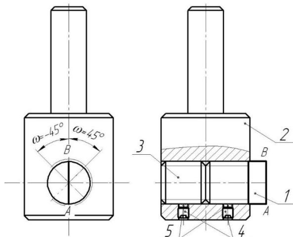
Рисунок 2 – Конструкция экспериментальной концевой цилиндрической фрезы с возможностью изменения угла наклона винтовой режущей кромки АВ -  $\omega$
