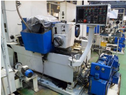
Рисунок 2 – Безцентрово-шліфувальний верстат SWaAKM25/1A для оброблення кінцевих роликів.
