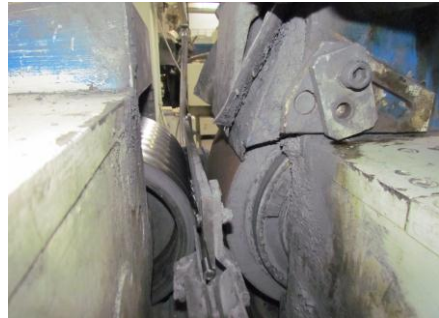
Рисунок 3 – Робоча зона безцентрово-шліфувального верстату SWaAKM25/1A.
