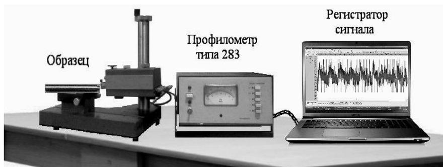
Рисунок 6 – Регистрация параметра шероховатости  $R_a$  посредством профилометра типа 283 и ноутбука
