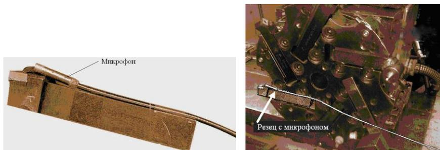
Рисунок 7 – Размещение микрофона на резце
