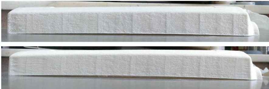
Рисунок 4 – Изделия с остаточной деформацией (ось X ) по триангуляционной модели с компенсирующей деформацией (сверху) и по исходной триангуляционной модели (снизу)
