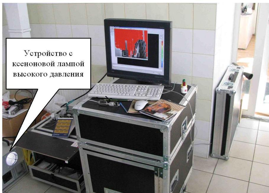
Рисунок 2 – Оптико-цифровая установка объемного сканирования Imetric IScan II
