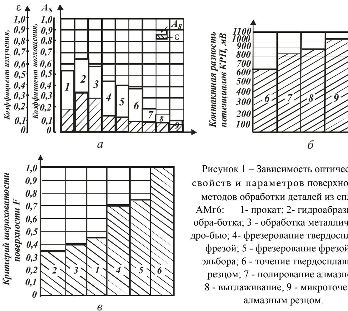
Рисунок 1 – Зависимость оптических свойств и параметров поверхности от методов обработки деталей из сплава АМг6: 1- прокат; 2- гидроабразивная обработка; 3 - обработка металлической дробью; 4- фрезерование твердосплавной фрезой; 5 - фрезерование фрезой из эльбора; 6 - точение твердосплавным резцом; 7 - полирование алмазное; 8 - выглаживание, 9 - микроточение алмазным резцом.
