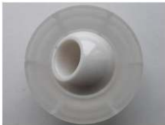
Рисунок 2 – Пара трения вкладыш вертлужной чаши из сапфира – бедренная головка из ZrO 2 -керамики.
