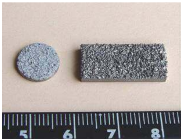
Рисунок 8 – Образцы титана с покрытием из биоактивной керамики на основе гидроксилапатита
