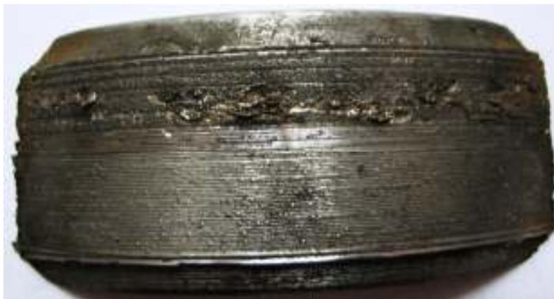
Рисунок 4 – Вигляд поверхні після дискретного зміцнення (до шліфування)
