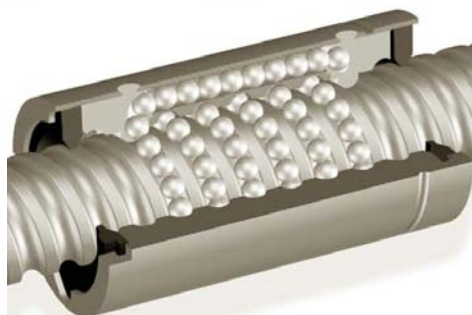
Рисунок 3 – Возврат шариков от последнего витка к первому
