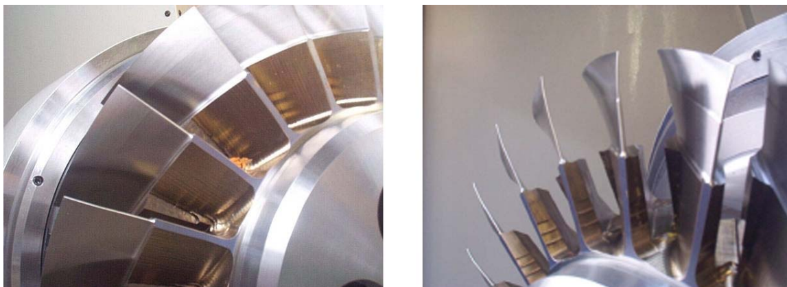
Рисунок 1 – Лопатки осевого колеса компрессора ГТД (пример защемленной пластины сложной формы)
