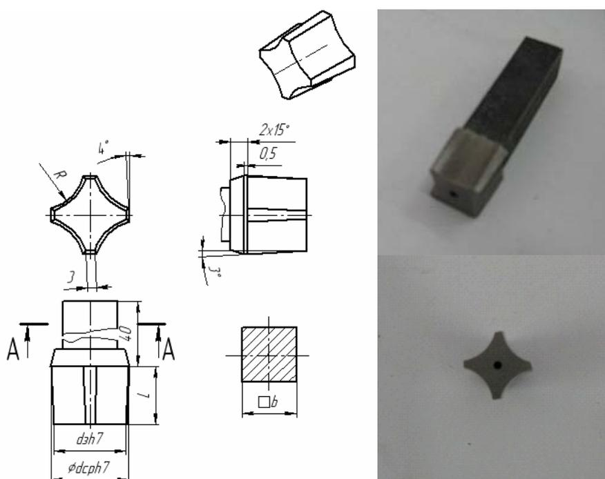
Рисунок 2 – Деформирующий инструмент для глухих отверстий
