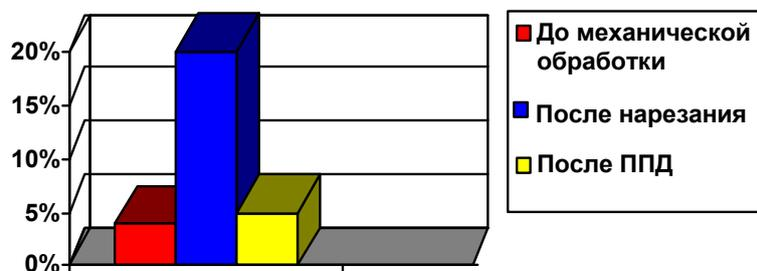
Рисунок 6 – Количество негерметичных деталей в зависимости от вида обработки
