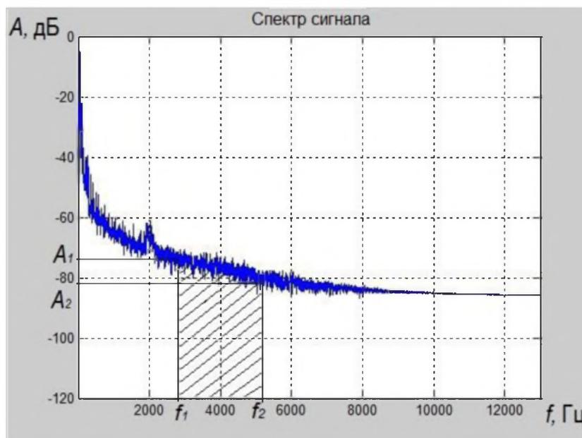
Рисунок 3 – Графическая интерпретация мощности вибрационного сигнала
