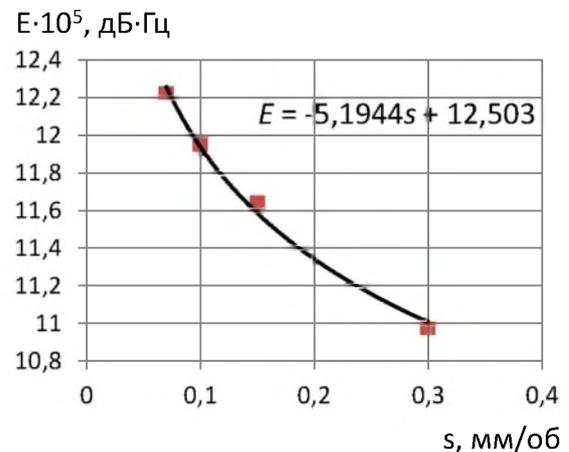
Рисунок 5 – Зависимость мощности вибрационного сигнала  $E$  от подачи  $s$  ( $t=0,3$  мм;  $V=100$  м/мин)
