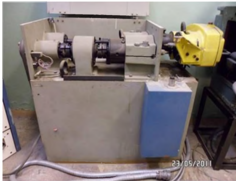
Рисунок 1 – Специальная машина трения СМТ-1С испытания закаленных цилиндрических зубчатых колес
