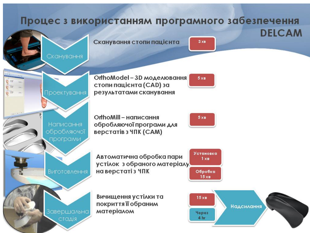
Рисунок 5 - Процес виготовлення ортопедичного взуття та устілок з використанням програмних продуктів фірми Delcam
