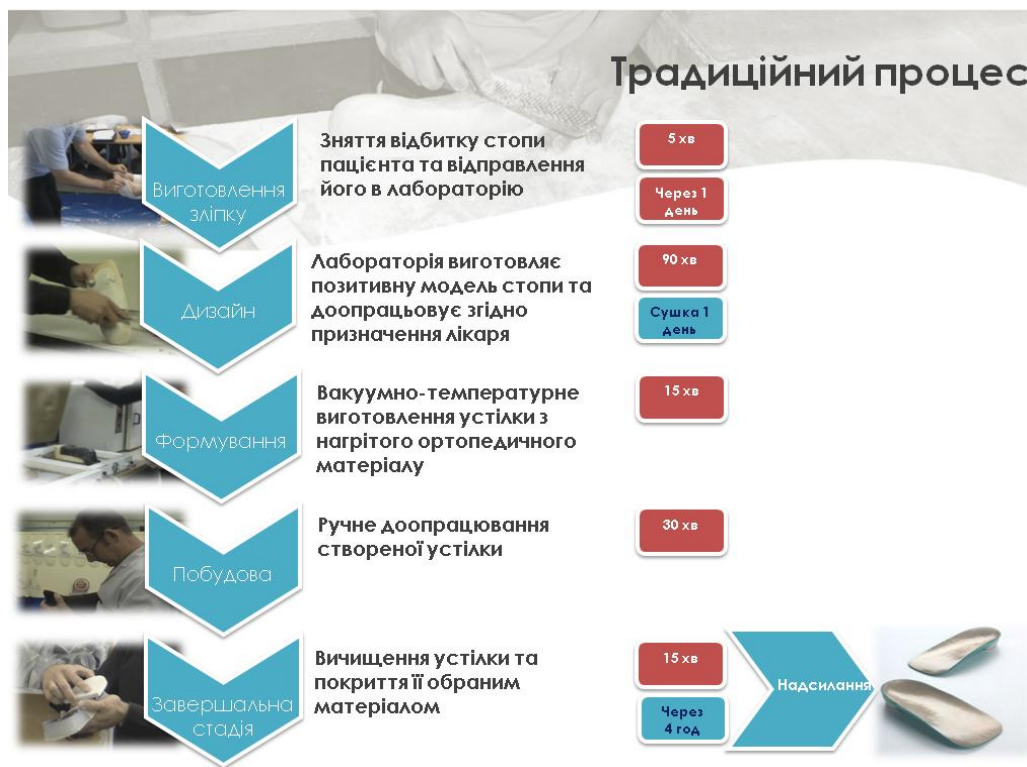
Рисунок 4 - Традиційні процеси виготовлення ортопедичного взуття та устілок
