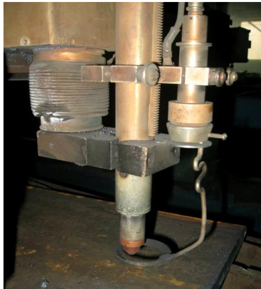
Рисунок 5 – Резак плазменной резки
