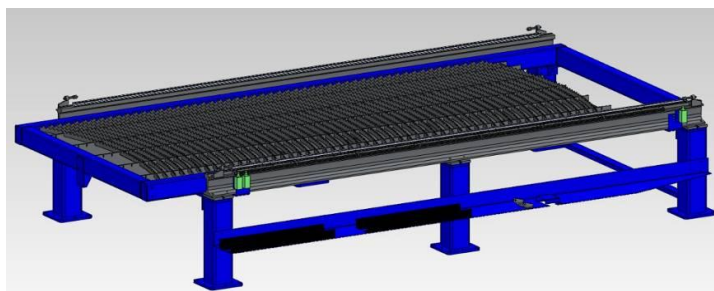
Рисунок 8 – Стол плазменной установки «Харьков-П1»
