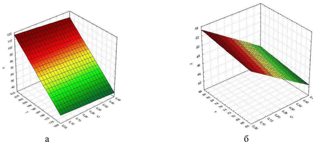
Рис. 3. Зависимость количества гельфракции ( $Y$ , %) ВПЭ от: а) температуры литья (°С) и концентрации перекиси дикумила (%); б) времени литья изделия ( $\tau$ ) и концентрации перекиси дикумила (%)
