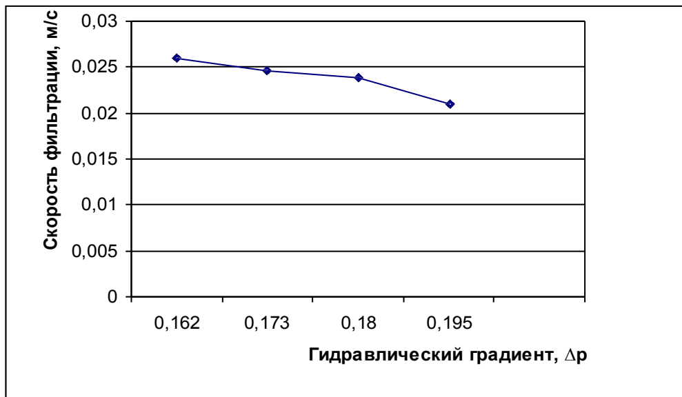
Рис. 3. Зависимость скорости фильтрации песка от градиента напора
