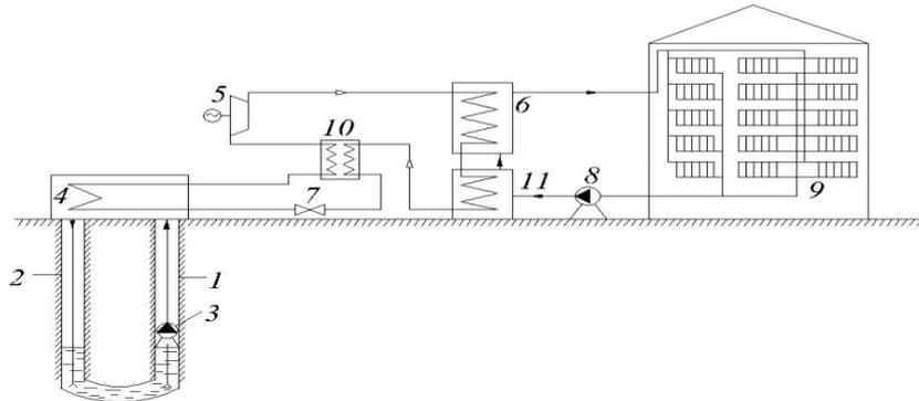
Рис. 3. Схема ТНУ от источника грунтовых вод с промежуточным теплообменником и переохладителем
