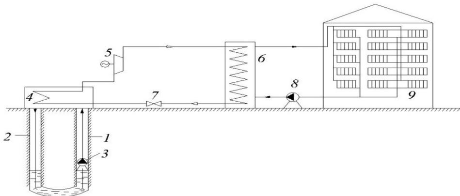
Рис. 1. Схема ТНУ от источника грунтовых вод
