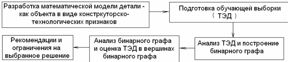
Рис. 3 – Общая последовательность работы модулей программы «Классификатор листовых деталей для импульсной обработки программы»
