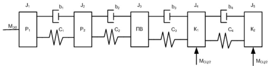
Рис. 1. Структурная схема электромеханической системы ТАД – колесная пара
