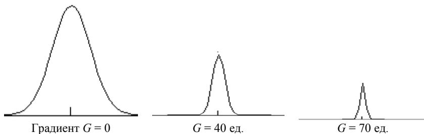
Рис. 2. Импульсы эхо-сигнала при различных значениях градиента
