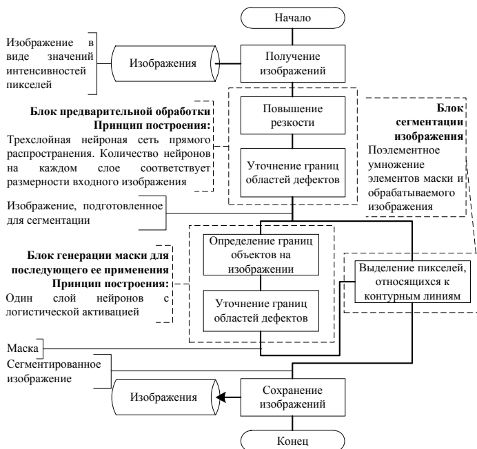
Рис. 3. Схема нейросетевой структуры для сегментации низкоконтрастного изображения
