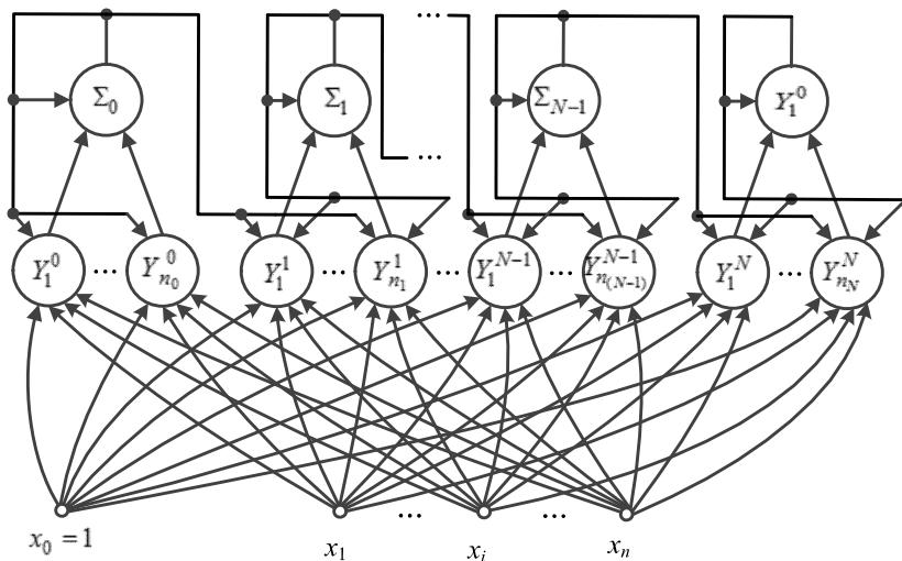
Рис. 5. Архитектура нейронной сети Хебба, которая может дообучаться  $N$  раз
