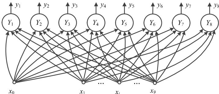
Рис. 3. Нейронная сеть Хебба с дополнительными запоминающими нейронами
