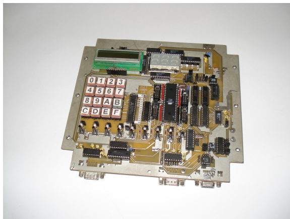
Рис. 3. Электронный блок стенда отладки микропроцессорных приборов
