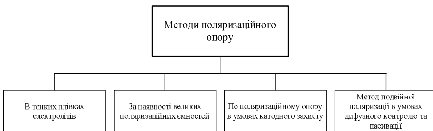
Рис. 1. Електрохімічні методи контролю корозійних процесів
