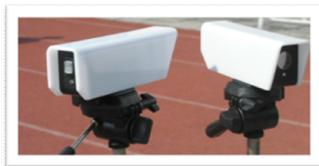
Рис. 1. Однолучевой оптический створ. ИК-излучатель и приемник разнесены.
